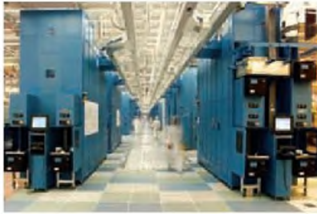
▲ Figura 12.9 Fabricación de chips de silicio. Cuarto limpio de IBM para la fabricación de obleas de silicio de 300 mm, en East Fishkill, New York. Tom Way/Cortesía de International Business Machines Corporation. No se permite su uso sin autorización.
